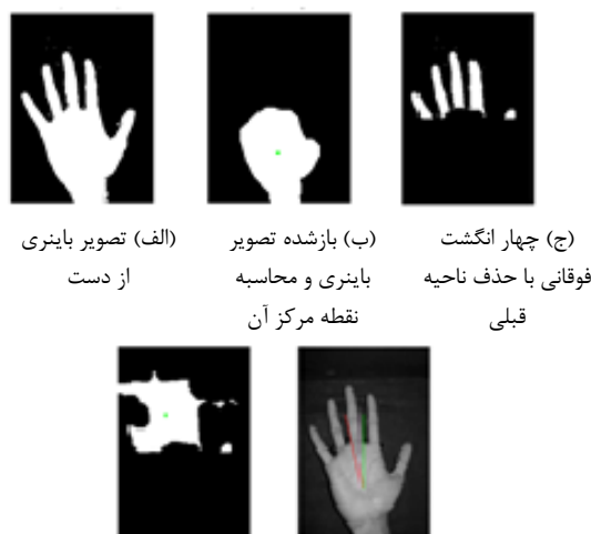
شکل (۲). روند محاسبه میزان انحراف تصویر دست. خط قرمز بیانگر انحراف تصویر از معیار عمودی که با خط سبز نشان داده شده است. در این مثال میزان انحراف 9/019 درجه بوده است.
