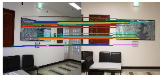
ب) ۴۷ نقاط تطبیقی استخراج شده توسط الگوریتم RANSAC شکل (۱). یافتن نقاط تطبیقی توسط الگوریتم ORSA و RANSAC
